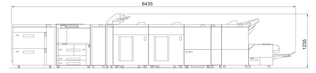
\* 大容量給紙トレイ B1-S、大容量給紙トレイ C3-DS、エアーサクション給紙トレイ C1-DS は、同じサイズです。 大容量給紙トレイ B1-S は、Revoria Press E1136P には装着不可。 設置面積図 単位: mm
